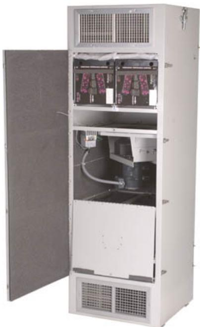
Le PPU est un système pré-configuré, de purification d'air, conçu pour fournir l'air de surpression et de recyclage, dans des salles qui ont besoin d'un environnement contrôlé. Prévu pour fonctionner de façon autonome il apporte jusqu'à 50% d'air neuf et 50% d'air recyclé du débit initial lorsque la pressurisation et la recirculation de l'air sont nécessaires.
